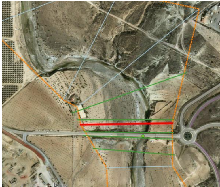
Figura 13-35.- Superposición de modelos. La sección marcada en rojo, perteneciente al modelo principal, se eliminará para insertar el submodelo
