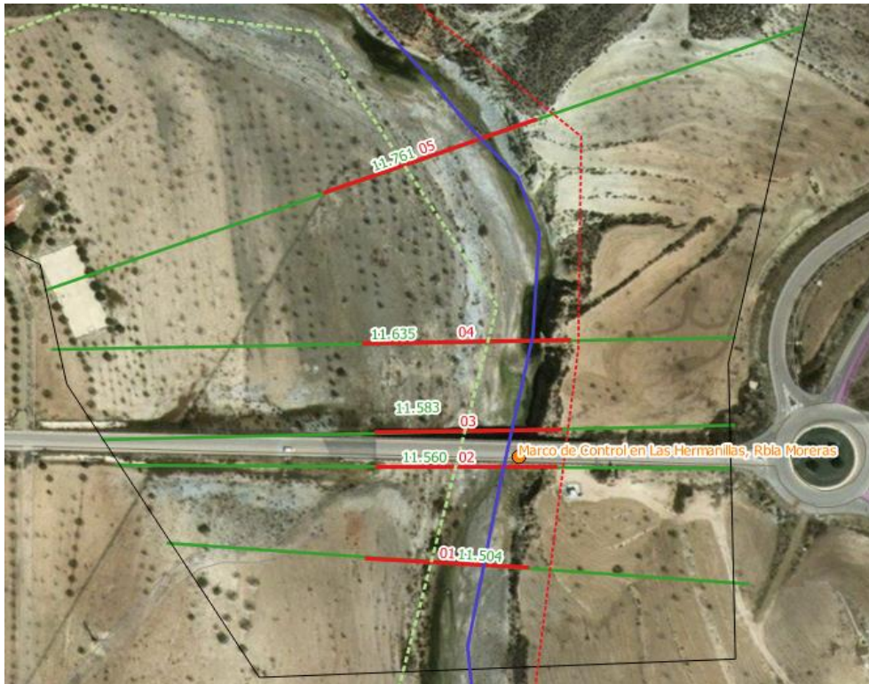
Figura 13-32.- Digitalización de secciones extendidas
