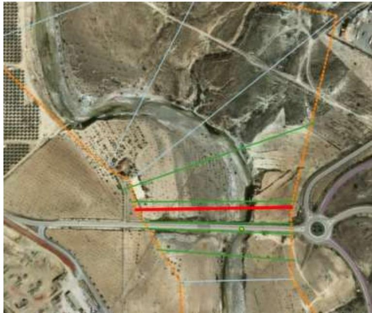
**Figura 19-35.- Superposición de modelos. La sección marcada en rojo, perteneciente al modelo principal, se eliminará para insertar el submodelo**
